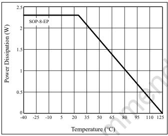
Figure 34 Dissipation Curve (SOP-8-EP)
