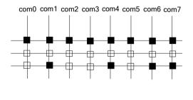
Reg\_Seg={com7,com6,com5,com4,com3,com2,com1,c om0} DISPDAT0=8'b11111111 DISPDAT1=8'b0000000 DISPDAT2=8'b11010010
