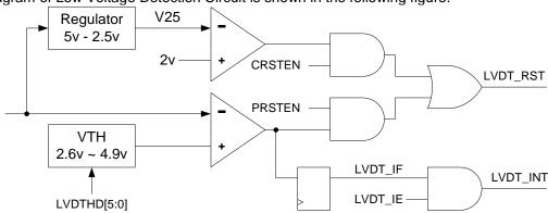
Figure-56. LVDT Diagram
